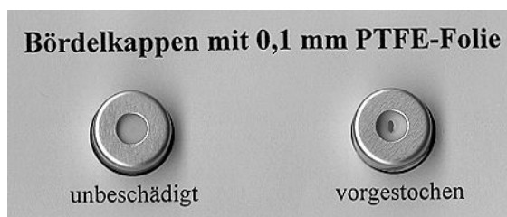
Abb. 1: Vorstechen eines Teflonseptums mit einer Spezialnadel - Schaffen eines Langloches zur zusätzlichen Entlüftung.
