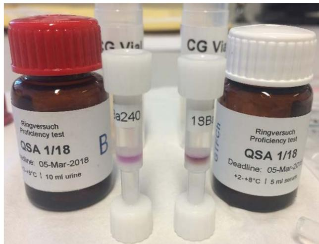
Abb. 2. Violette Farbbanden in den Festphasenextraktions-Mikrosäulen zeigen den Nachweis von Cyanid in den beiden Proben des Arvecon Ringversuches QSA 1/18 an: links Probe B Urin, rechts Probe A Serum.
