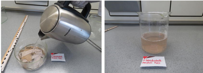
Abb. 16. links: Spülen mit kochendem Wasser, rechts: das Washwasser danach.
