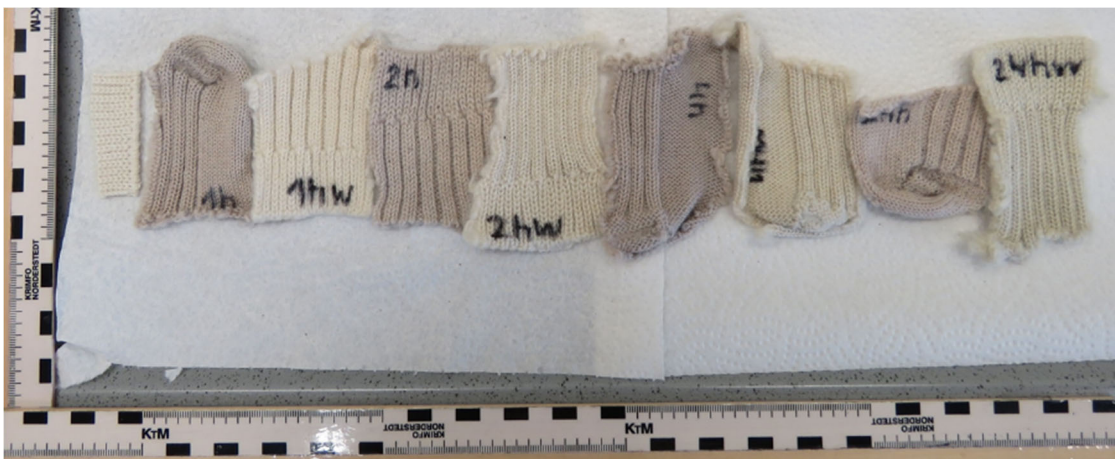
Abb. 12: Unbehandelter Wollstreifen (links) und für 1, 2, 4 bzw. 24 h kaltgefärbte Wollstreifen in trockenem Zustand, nach Handwäsche (ohne weitere Kennzeichnung) bzw. Wäsche mit Waschvollautomat (Kennzeichnung „w“) (v. l. n. r.). Siehe auch Fußnote h .
