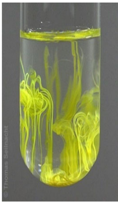
Abb. 3. Fällung von Bleiiodid ( \text{PbI}_2 ) mit einer wässrigen Lösung von Kaliumiodid (KI). Abbildung aus: www.seilnacht.com/Lexikon/82Blei.htm . Mit freundlicher Genehmigung vom 10.03.2022 von Thomas Seilnacht.
