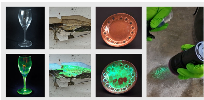
Abb. 9. Bleidetektion (Lumetallix-Testkit) mit Perovskit-basierter Photolumineszenz. Oben das Objekt unter Tageslicht, darunter unter UV-Licht (365 nm) v. l. n. r.: Weinglas aus Bleikristall, Wandfarbe und Keramik mit bleihaltigen Pigmenten, Abdruck einer mit Blei kontaminierten Schuhsohle.
